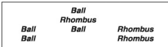
Entgegenkommendes manövrierbehindertes Fahrzeug von vorn, mit Fahrt durchs Wasser, das Unterwasserarbeiten ausführt (z. B. baggert).
