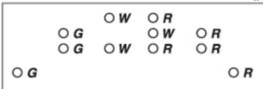
Manövrierbehindertes Fahrzeug, Länge wahrscheinlich 50 m oder mehr, von vorn mit Fahrt durchs Wasser, das Unterwasserarbeiten ausführt (z. B. baggert).
