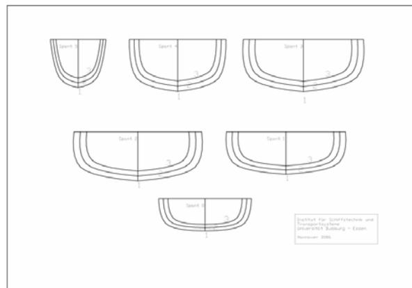
**Abbildung 2: Querspannten**
