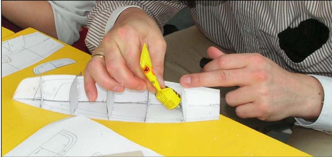
**Abbildung 3: Aufkleben der Spanten**
