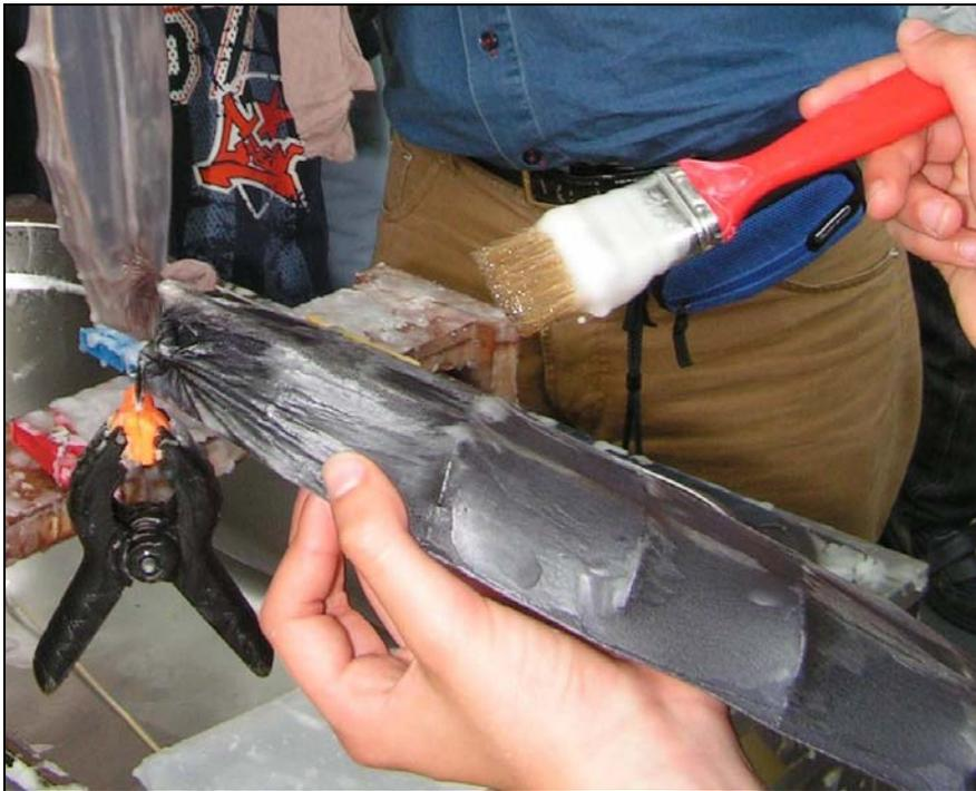
**Abbildung 6: Das Schiff wird mit flüssigem Wachs bestrichen**
